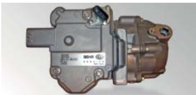
Compresor de alto voltaje
